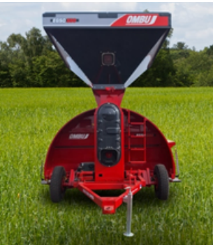
Máquina en posición de trabajo con patas de apoyo traseras para sacar el tractor.
