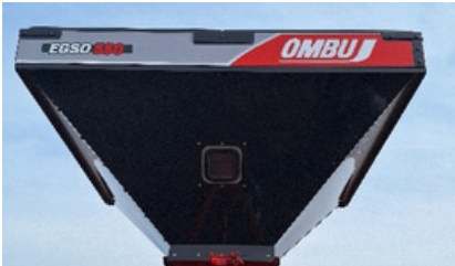
Tolva de gran capacidad con tapas rebatibles y visor de carga .
