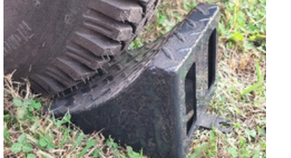
Cuña para frenado de la máquina en reposo.
